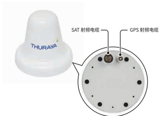
天线单元的基座处有两个射频(母头)连接器。一个连接器是 **SAT 信号端口** (N 型连接器), 另一个是 **GPS 信号端口** (SMA 连接器)。
