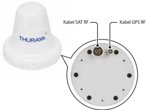
Unit antena memiliki dua konektor RF (female) di bagian dasarnya. Satu konektor adalah **port sinyal SAT** (konektor tipe N), dan yang satunya adalah **port sinyal GPS** (konektor SMA).
